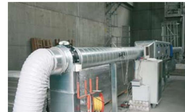
Abbildung 1: Filterprüfstand am Plabutschtunnel
